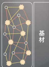
塗膜の中でネットワークが再構築され安定した塗膜を形成する
